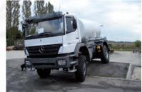
Les citernes et autres superstructures pour poids lourds L & F sont équipées de notre système breveté « *L&F Low-Torsion body mounting system* » qui garantit la plus grande flexibilité et robustesse même sous des conditions d'utilisation extrêmes et protège la superstructure des forces de torsion jusque sur des routes et terrains les plus exigeants.
