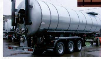
Choisissez parmi nos différents systèmes de chauffage et isolations d'une épaisseur jusqu'à 100 mm qui permettent de transporter du bitume à une température jusqu'à 250°C.
