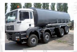
Avec une capacité de 4 000 à 30 000 litres pour les citernes sur porteur et 20 000 à 60 000 litres pour celles sur semi-remorque nos véhicules sont – en fonction du modèle – appropriés au transport du diesel, de l'essence, du kérosène, du pétrole brut et des huiles lourdes. Il est bien entendu que toutes nos citernes sont conçues dans le respect absolu des directives ADR.
